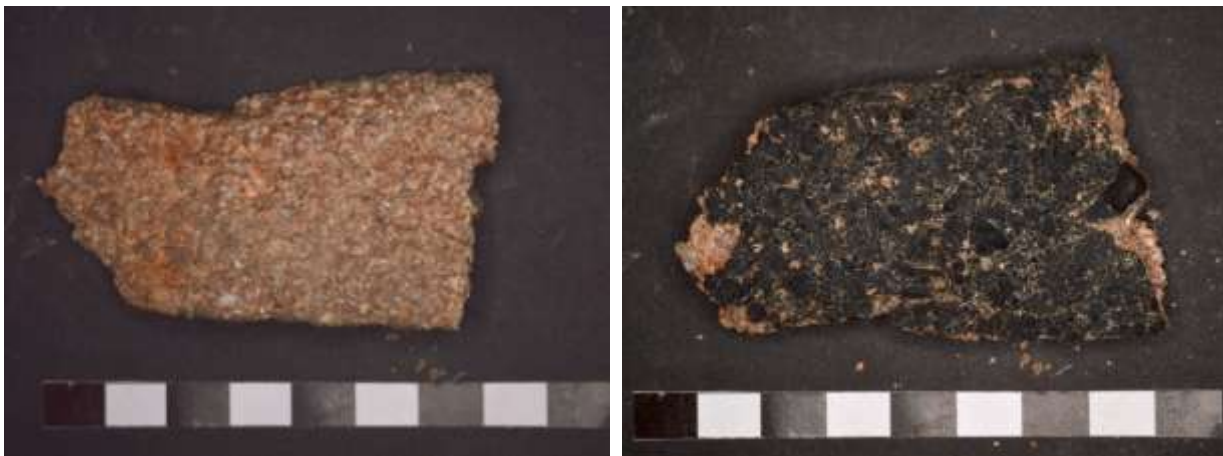
Obrázek 4 a 5: Lomová plocha a líc části vzorku kamene fasády prelatury, povrch kamene (vpravo) nese černě zbarvenou sádrovcovou krustu s nečistotami, dílek měřítka odpovídá 1 cm
