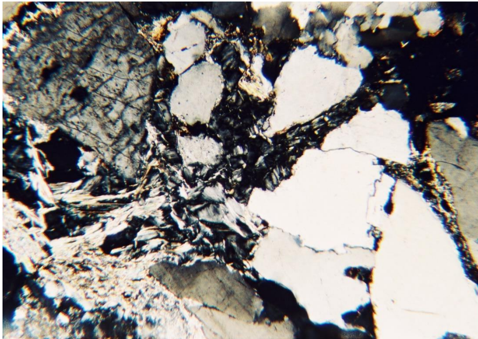
Pískovec křemenný, arkózovitý – arkóza, hrubozrnný, silicifikovaný vzorek VZ-5518, parapetní římsa, zvětšení 32x, nikoly II struktura slídnato-křemenné (kaolinitické) základní hmoty v IKP
