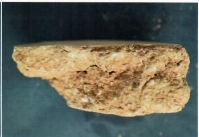
Obr. 3: úlomek dlaždice s cihlovým povrchem. 3a. Líc dlaždice, 3b. Rozhraní povrchu a difuzního barevného přechodu povrchu k jádru dlaždice. 3c. Detail rozhraní povrchu a difuzního barevného přechodu povrchu k jádru dlaždice
