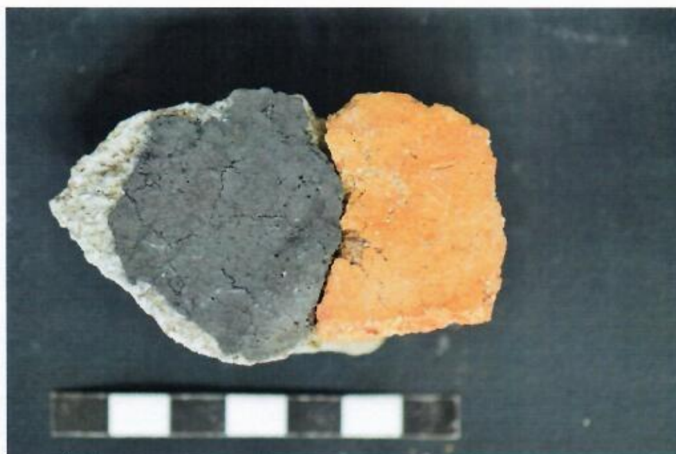
Obr. 5: Černá dlaždice. Levá část nevypálená, pravá část – změna barevnosti po pálení úlomku dlaždice
