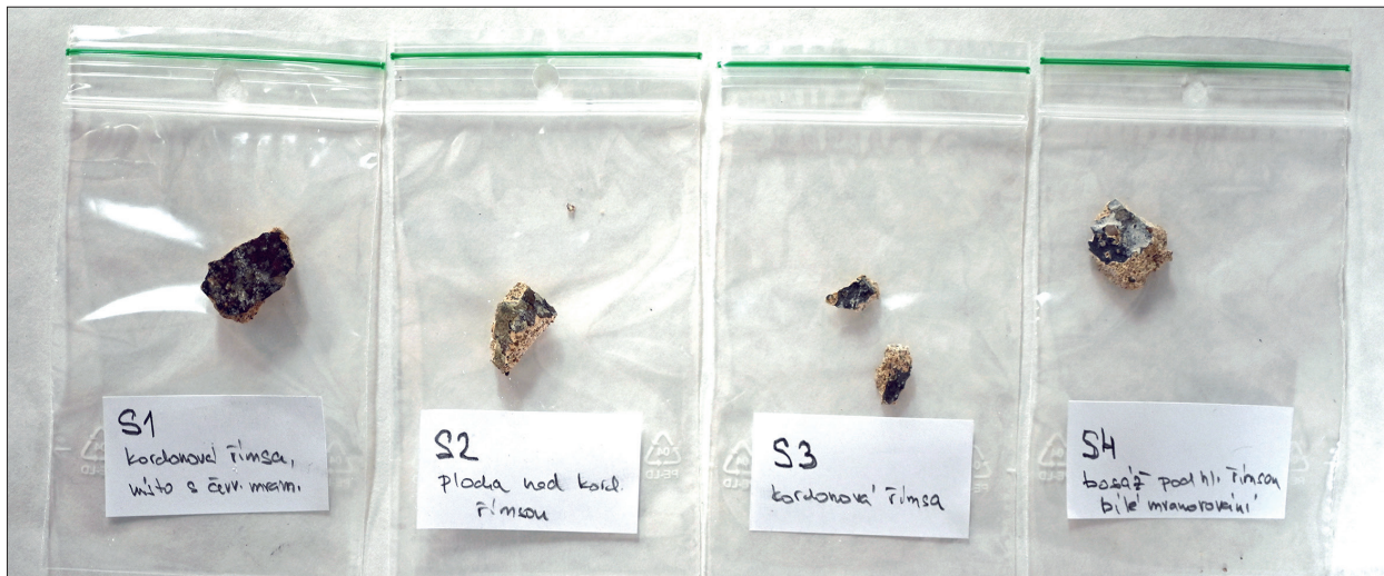
Obr. 7. Pečlivost a systematická odběr, označení a uložení vzorků pro zpracovatele laboratorního průzkumu odráží skutečný zájem zadavatele o výsledky laboratorního šetření.
